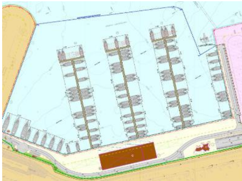
Εικόνα 1: Κάτοψη προτεινόμενων λιμενικών έργων
