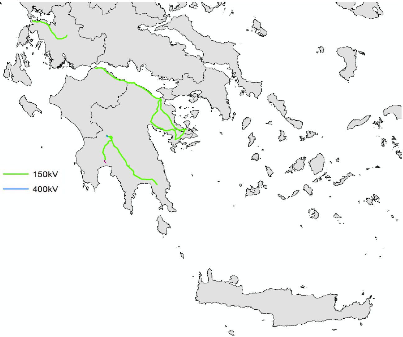
Εικόνα 2 : Παρουσίαση αδειοδοτημένων Γραμμών Μεταφοράς 400kV & 150kV
