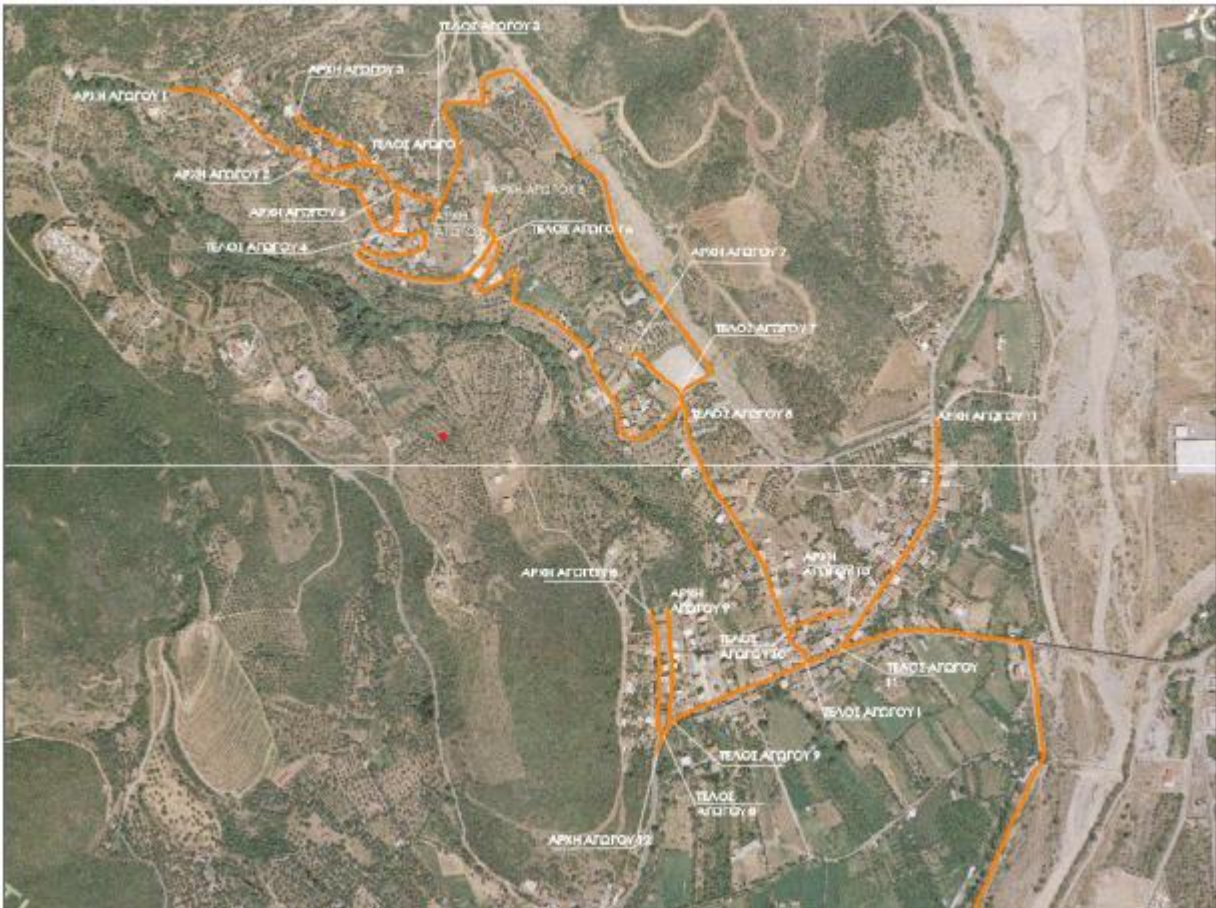
Εικόνα 2: Διάταξη του αποχετευτικού δικτύου του οικισμού Δάφνης
